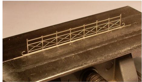
Die Schwellen liegen im Abstand von 5,25mm, also immer 2 zwischen 2 Querträgern. Sie werden auf die inneren Langträger geklebt.
